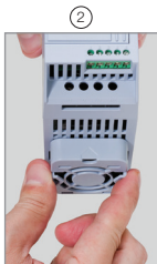
Liberação das travas para remoção do ventilador
