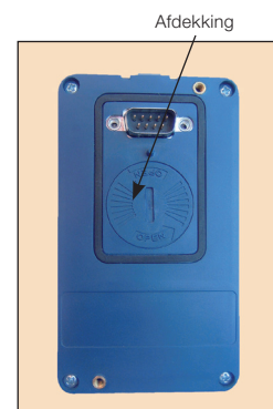
Afbeelding 30: Batterijdeksel op het bedieningspaneel
