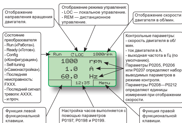
Рис. 30.: Дисплей клавиатуры и пример отображения функций по умолчанию (режим контроля)
