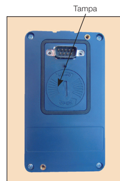
Figura 31: Localização da tampa de acesso à bateria
