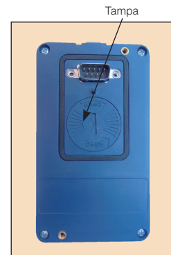
Figura 31: Localização da tampa de acesso à bateria
