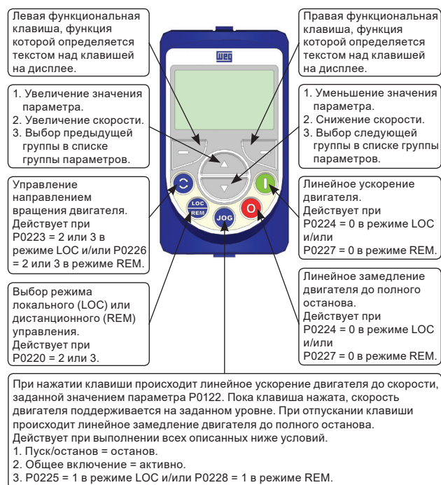
Рис. 29.: Внешний вид и функции клавиатуры
