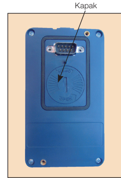
Şekil 31: Pile erişim için tuş takımı pil kapağı
