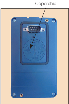
Figura 31: Coperchio batteria tastiera per accesso alla batteria
