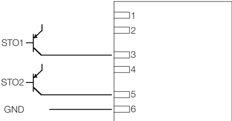
Figura 2.3: Instalação utilizando sinais OSSD
