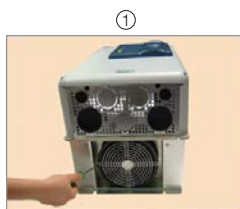
Remoción de los tornillos de la rejilla del ventilador
