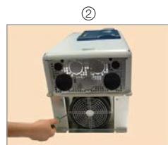
Fijación del ventilador y de la rejilla en el producto
