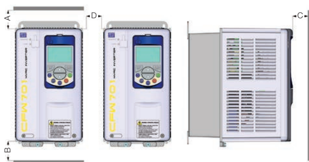
(c) Minimum ventilation free spaces (c) Espacios libres mínimos para ventilación (c) Espaços livres mínimos para ventilação
