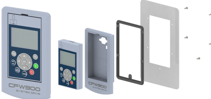
Figure A.6: Panel door mounting Figura A.6: Montaje en la puerta del tablero Figura A.6: Montagem na porta do painel
